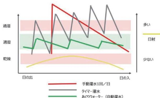
作物の蒸散量は、多くの場合日射量に比例すると考えられます。そこで、日射量に応じた灌水の頻度・タイミングを適正に制御する灌水方法が「日射比例式灌水」です。「あぐりウォーター」は日射センサーを標準装備、タイマーや朝一灌水との組み合わせによる複合制御で作物にとって最適な灌水・施肥制御を実現します。
